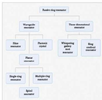
Рис. 1. Типы пассивных кольцевых резонаторов, рассматриваемые в качестве чувствительных элементов МОГ
